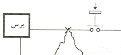
شکل (۶-۷) اتصال ناخواسته سیم‌های ارتباطی موجب حرکت پرس می‌شود
