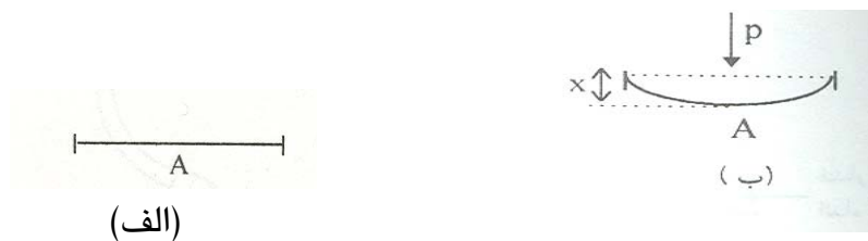
شکل (۳-۴۷). اصل مورد استفاده در اندازه‌گیر فشار یا دیافراگمی
